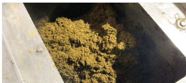
L'Xpress PS mélange et chauffe les fibres séparées.
